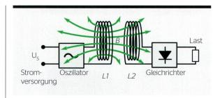
Prinzip der induktiven Energieübertragung im Nahfeld.
