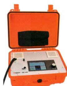
Hoher Prüfstrom bis zu 1000 A.
