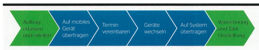
Bild 1 Prozess Datenfluss bei Zählerwechsel.
