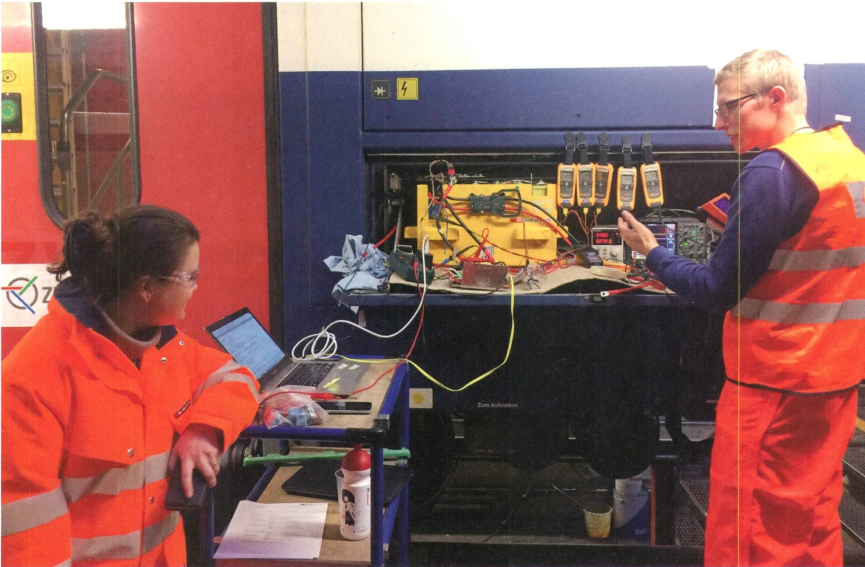
Lea Steurs von den SBB (Management und Protokollierung des Testablaufs) und Christian Vögtli von der BFH testen das Funktionsmuster auf dem Regionalzugwagen DPZ.
