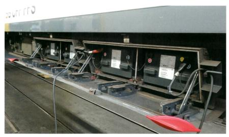
Der Reisezugwagen EW4 führt zwei parallele 36-V-Batteriestränge mit, aktuell in vier Trögen mit je einer 18-V-Bleibatterie untergebracht.
