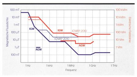
**Bild 2** Die Grenzwerte der Verordnung zum Schutz vor nicht-ionisierender Strahlung (NISV) begrenzen elektromagnetische Felder von Infrastrukturanlagen, etwa der Energieversorgung. IGW = Immissionsgrenzwert der NISV; AGW = Anlagegrenzwert der NISV; ICNIRP 2010 = Empfehlung der Internationalen Kommission für den Schutz vor nichtionisierender Strahlung. Gegen die Belastung durch elektromagnetische Felder am Arbeitsplatz gibt es zudem Grenzwerte der Suva.
