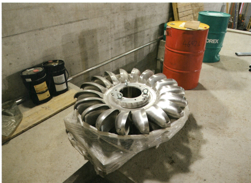
Auch ein Ersatz-Pelton-turbinenrad ist bereits vor Ort.
