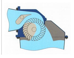
In Realp wird die Durchströmturbine mit horizontalem Zufluss eingesetzt.
