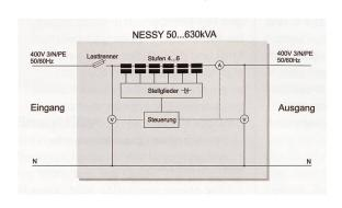
Je nach Spannungsabweichung werden ein bis sechs Transformatoren in Phase oder Gegenphase zugeschaltet.
