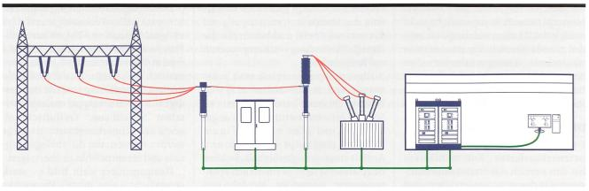
Bild 2 Digital Substation mit Prozessbus.
