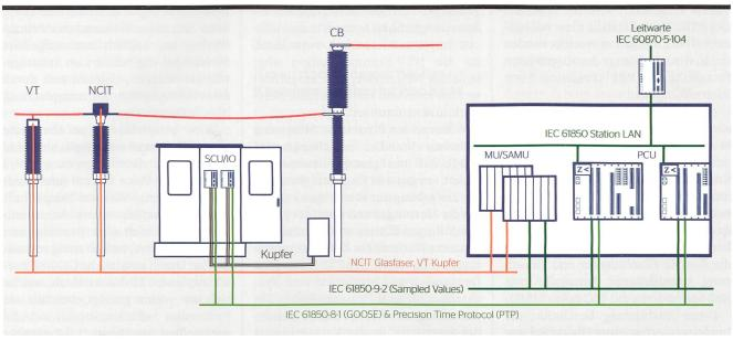
Bild 3 Kommunikationsschema der Digital Substation.
