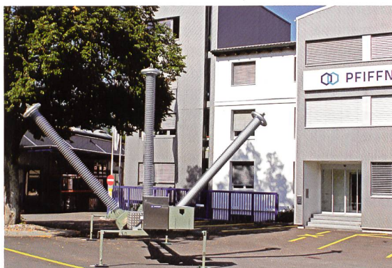
Eine Mobile Messstation, 3-Phasen RC-Teiler.
