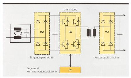
Bild 1 Störungslokalisierung in einem AC/DC-Wandler.
