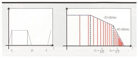
Bild 2 Spektrum der Ausbreitung von Schaltoberschwingungen.
