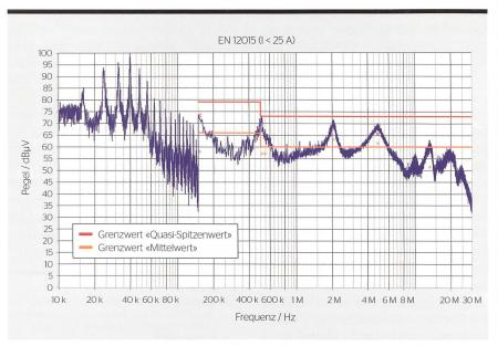
Bild 4 Schaltoberschwingungen und breitbandige Störungen.
