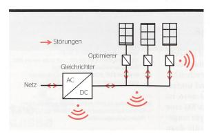
**Bild 5** Solaranlagen können auf unterschiedliche Weise stören.
