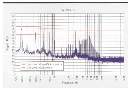
**Bild 3** Leitungsgebundene Emissionen am DC-Eingang eines Solarwechselrichters.
