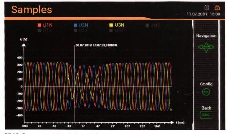
**Bild 2** Spannungseinbruch (Samples) während eines Sommergewitters in der Haupteinspeisung eines Elektronikproduzenten.
