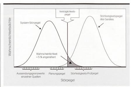
Bild 1 Prinzip der elektromagnetischen Verträglichkeit.
