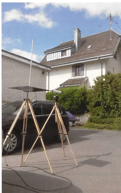
Figure 4 Antennes pour les mesures des perturbations électromagnétiques.
