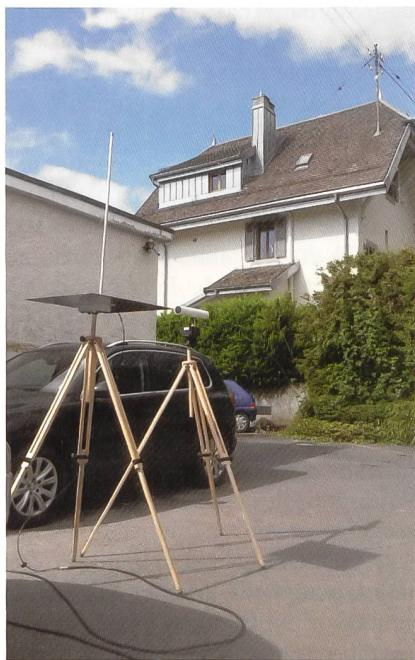
**Figure 4** Antennes pour les mesures des perturbations électromagnétiques.
