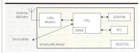
Bild 4 Schematische Darstellung eines Smart-Lora-Moduls.
