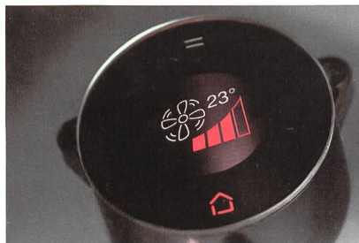
Schalter mit kapazitiver Touch-Technologie.
