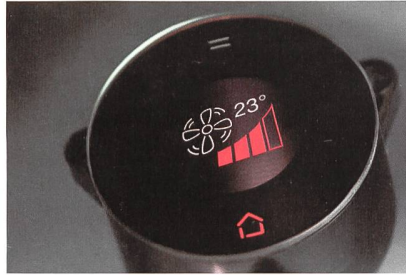
Schalter mit kapazitiver Touch-Technologie.
