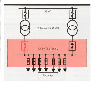
**Bild 4** Stromverteilung bei Erdschluss.
