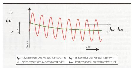
Bild 1 Definition der Ströme im Kurzschlussfall.
