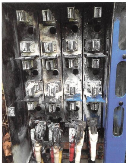
Bild 6 Durch Kurzschluss beschädigte Schaltgerätekombination ohne korrekte Schutzauflösung.
