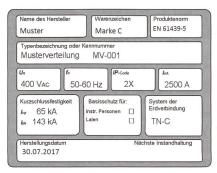
**Bild 3** Auf dem Typenschild der Schaltgerätekombination ist die Kurzschlussfestigkeit angegeben.
