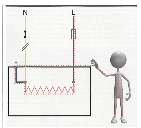
**Bild 2** Bei einem Neutralleiter-Unterbruch können gefährliche Zustände entstehen. Eingelegte Brücke zwischen Neutralleiter (gelb) und dem leitenden Gehäuse.
