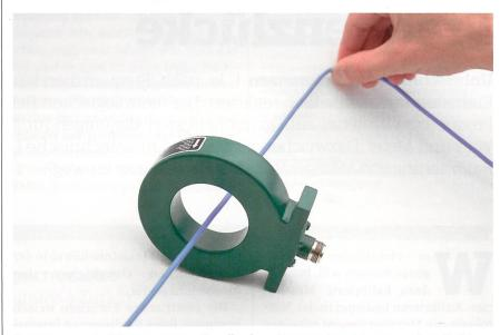
Stromzangen sind Spannungswandler, die einen Frequenzbereich von wenigen Hz bis zu mehreren MHz abdecken können. Die Spannung am Anschluss ist proportional zu dem durch die Zange fliessenden Strom.
