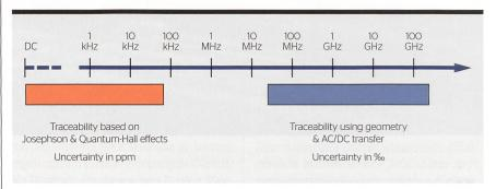
Die Realisierung eines DC-Volts unterscheidet sich komplett von der Realisierung eines Volts bei einer Frequenz von 1 GHz – in der Mitte klafft eine Lücke.
