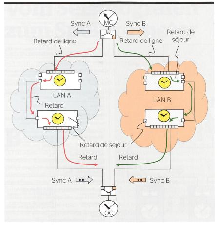
Figure 10 Principe des horloges en redondance parallèle.
