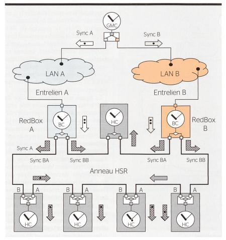
**Figure 11** Principe de la redondance parallèle avec PRP (en haut) et dans l'anneau HSR (en bas).
