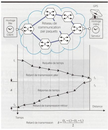
Figure 1 Exemple de requête de temps SNTP.
