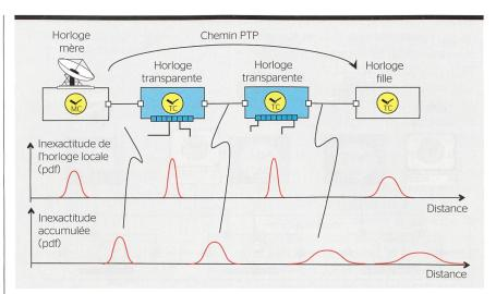
Figure 7 Diminution de la précision en chemin.
