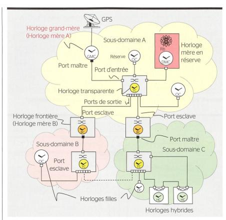
Figure 2 Éléments d'une distribution horaire PTP.
