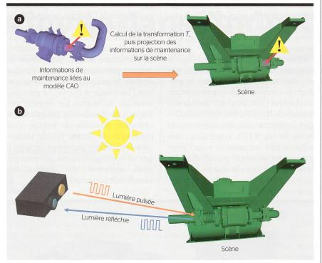
**Figure 4** Principe de reconnaissance automatique des pièces du transformateur, puis projection des informations de maintenance (a) et scan 3D de la surface du transformateur par la technologie temps de vol (b).
