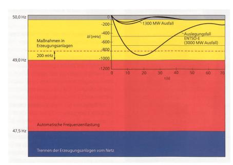
Bild 1 Massnahmen zur Frequenzstabilisierung.
