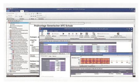
Bild 3 Eingabe der Einstellwerte zur automatischen Prüfung.
