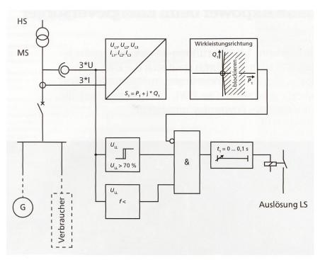
Bild 2 Prinzipschaltung der wirkleistungsrichtungsabhängigen Frequenzschutzfunktion.
