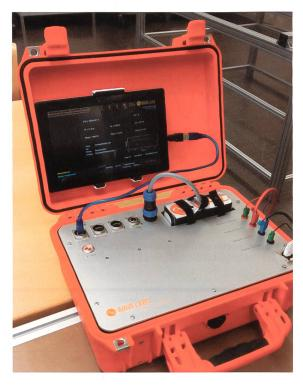
**Bild 4** Die Auswerteelektronik wird von einer Batterie gespiesen und die Auswertung der Messung erfolgt direkt auf dem Tablet mit Touch-Screen.
