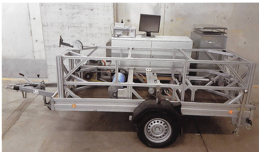
Bodenstation mit Seilführung, Seilwinde, Generator, Leistungselektronik und Bremswiderstand.
