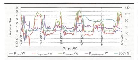
**Figure 4** Puissances échangées dans le microréseau: avec les batteries (Psoc), les panneaux PV (Pproduction), les charges (Pconsommation) et le réseau (Pexport\_Rés). SOC: état de charge des batteries
