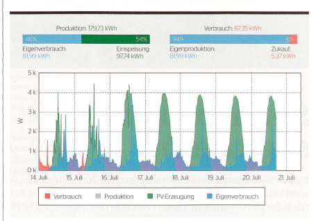
**Bild 2** Wochenverlauf der Erzeugung einer 6-kW-PV-Anlage mit Lithium-Batteriespeicher 6 kWh versus Stromverbrauch mit zusätzlicher Stromlieferung von 6 % vom Netzbetreiber (www.sunny-solartechnik.ch).
