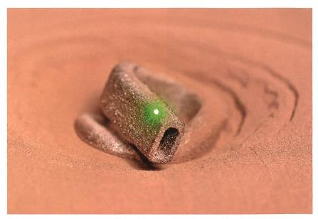
Mit dem neuen Prozess sollen sich Bauteile aus reinem Kupfer additiv fertigen lassen.
