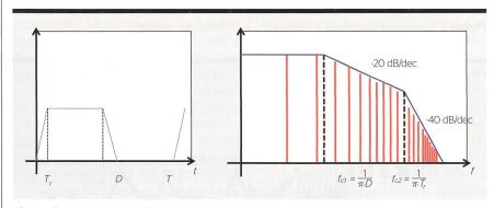
Figure 2 Propagation fréquentielle des harmoniques de commutation.
