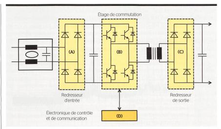
Figure 1 Localisation des perturbations dans un convertisseur AC/DC.
