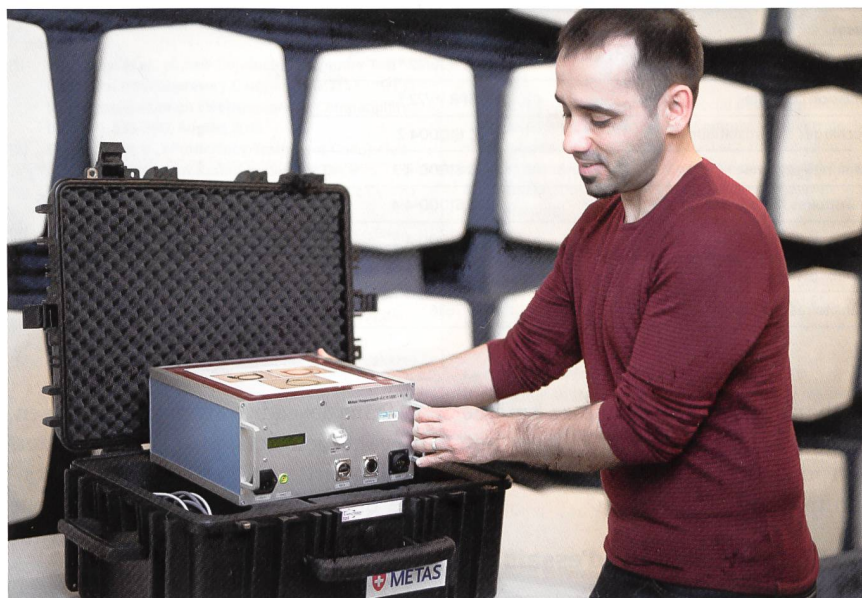
Figure 1 Appareil pour valider les essais d'immunité conduite selon la norme IEC 61000-4-3.
