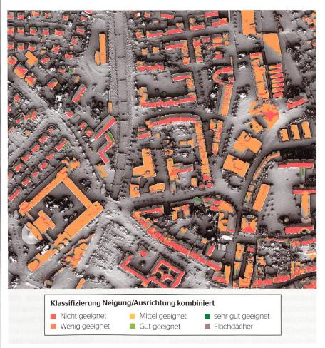
Bild 2 Solares Einstrahlungspotenzial auf Dachflächen.
