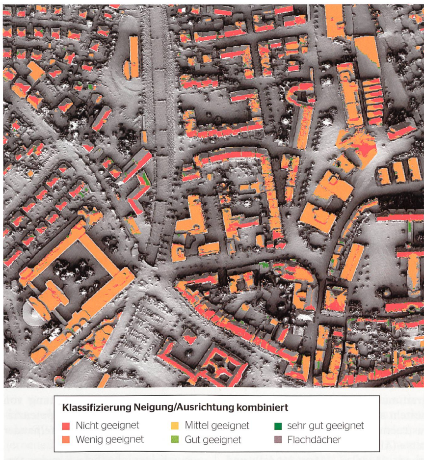
Bild 2 Solares Einstrahlungspotenzial auf Dachflächen.
