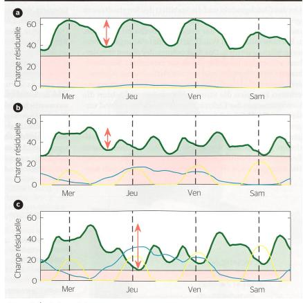
**Figure 4** Évolution schématique de la charge résiduelle aux trois stades de la transition énergétique. Stades préliminaire (a), initial (b) et avancé (c). Les opportunités financières des productions de pointe dépendent de l'amplitude de variation de la charge résiduelle (flèches rouges) et se réduisent initialement, avant d'augmenter à nouveau au stade avancé de la transition.
