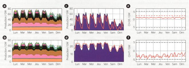
Figure 1 Production allemande réelle (b) et calculée par Eurotranselec (a). La ligne verte indique la consommation. Production réelle (courbe rouge) et calculée par Eurotranselec (bleu) de l'hydraulique de barrage en Suisse (c) et en Norvège (d). Puissance électrique calculée (ligne pleine) et moyenne mensuelle réelle (traitillé) échangée entre la Suisse et l'Allemagne (e) et l'Italie (f). Toutes les données correspondent à une semaine typique de l'hiver 2014-2015.
