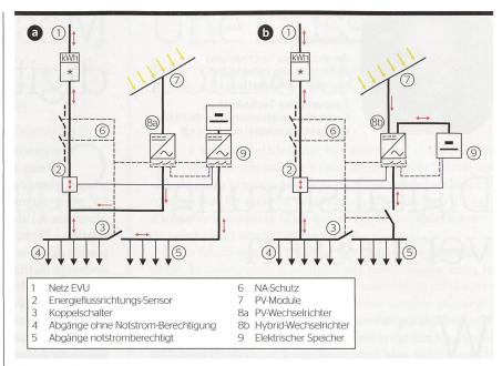
Bild 1 a) AC-gekoppeltes Speichersystem b) DC-gekoppeltes Speichersystem.
