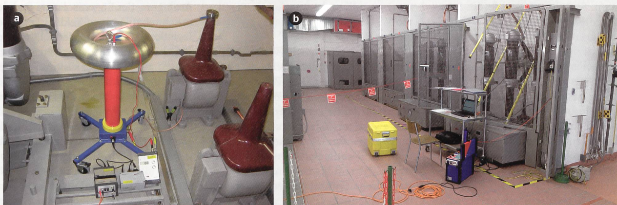
Bild 4 Die frequenzvariable Erregung eines Wandler und Erfassung der TE mittels eines Koppelkondensators vor Ort in einem Unterwerk der BKW. Der Schaltwagen ist ausgefahren, die Primäranschlüsse sind gelöst und die Sekundärklemmen geöffnet.
