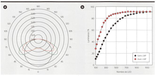
**Figure 2** Diagramme polaire de la distribution de lumière de LED simples (noir) et de LED équipées d'une feuille LMF contenant des pixels microstructurés (vert: plans C0-180 et C90-270; rouge: plan C45-225) (a). Uniformité de luminance d'un module de  $60 \times 60 \text{ cm}^2$  en fonction du nombre de LED (t = 1 mm; d = 15 mm) avec et sans feuille LMF (b).
