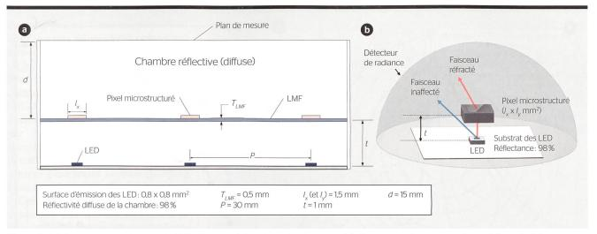
**Figure 1** Schéma en coupe du module LED développé dans le cadre du projet (a). Illustration du concept de modelage du faisceau basé sur l'utilisation de pixels microlenticulaires (b).
