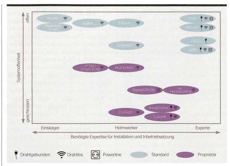
**Bild 1** Etablierte Bussysteme für das Smart Home. Nebst der Systemoffenheit [2] und der benötigten Expertise sind zahlreiche, weitere Kriterien ausschlaggebend bei der Auswahl geeigneter Bussysteme: Kosten, Funktionsumfang, Anzahl der Anwendungsbereiche, Eignung für die Nachrüstung, Skalierbarkeit, Zuverlässigkeit, Abhörsicherheit usw.
