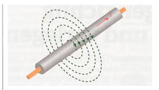
**Bild 1** Jeder stromdurchflossene Leiter erzeugt ein Magnetfeld.
