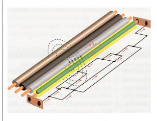
**Bild 2** Magnetfelder von Strömen in Leitern erzeugen induktive Wirkungen auf benachbarte Leiter und können «unerwünschte» Ströme erzeugen.
