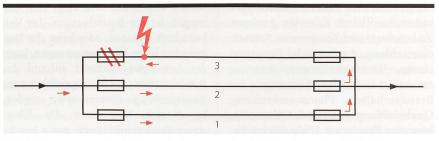
**Bild 3** Je nach Lage der Fehlerstelle kann es erforderlich sein, an beiden Enden der Leitung Überstrom-Schutzeinrichtungen anzuordnen.
