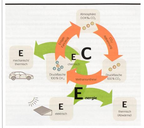
Schematische Darstellung des Kohlenstoffkreislaufs: Im CO<sub>2</sub> gebundener Kohlenstoff wird für höherwertige Produkte verwendet. Dieses Beispiel zeigt die Synthese zu Methangas, welches als Treibstoff verwendet werden kann.
