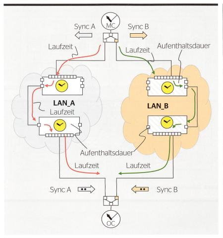
Bild 10 Prinzip der parallelen Redundanz für Uhren.
