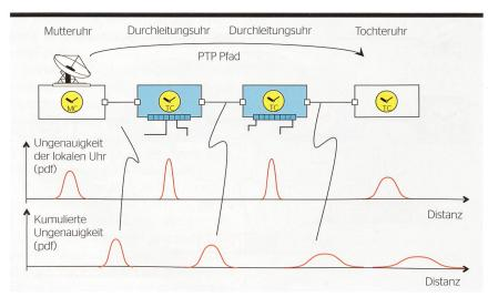
Bild 7 Abnahme der Genauigkeit entlang des Pfades.
