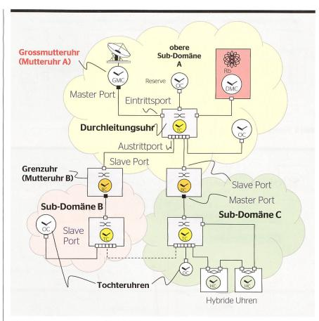
Bild 2 Elemente einer IEEE/IEC 61588-Zeitverteilung.
