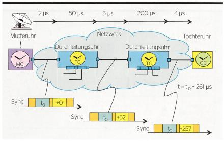
Bild 4 Prinzip der Zeitkorrektur in der IEEE/IEC 61588.
