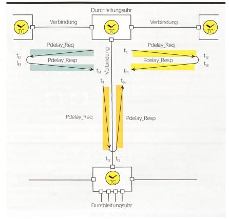
Bild 6 Prinzip der Laufzeiterfassung bei TCs.
