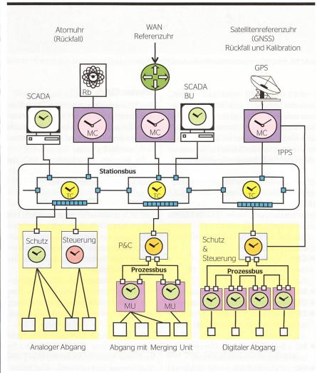
Bild 9 Zeitverteilung in einer Unterstation.
