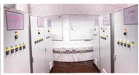
**Bild 3** Hardware-in-the-Loop-Testlabor in der Woodward Kempen GmbH für unabhängiges (automatisiertes) Testen von Wandler-, Generatoren- und Netzkonfigurationen.
