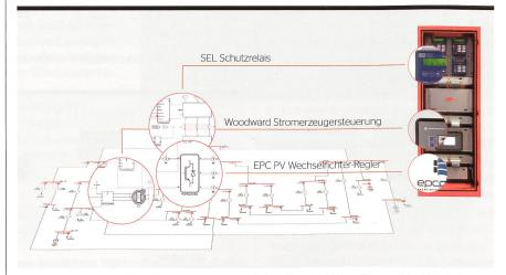
**Bild 5** Ein Microgrid Testbed beinhaltet ein Echtzeitmodell des Microgrids. Es wird unter anderem von einem Microgrid Controller, einem Wechselrichter-Controller, von einer Stromerzeugersteuerung und Schutz-Relais gesteuert.
