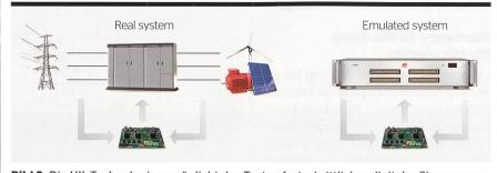
**Bild 2** Die HIL-Technologie ermöglicht das Testen fortschrittlicher digitaler Steuerungsund Kommunikationssysteme ohne jegliche Modifikation der vorhandenen Controller Hardware oder Software. Links befindet sich das reale System, rechts das HIL-Modell. Der Controller ist in beiden Fällen identisch.
