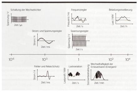
Bild 1 Relevante Zeitkonstanten im Verteilnetz.
