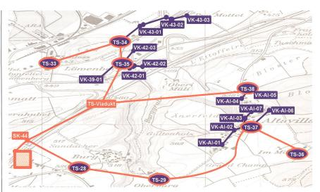
Bild 2 Darstellung der Netztopologie im Tool «ZNP light» (rot: NE 5, blau: NE 7).
