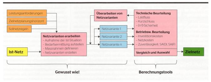
**Bild 1** Ausgehend vom bestehenden Netz werden auf der Basis der Leistungsanforderungen, des Zielnetzplanungshorizonts und der Sollnetzregeln verschiedene Netzvarianten erarbeitet, beurteilt und verglichen.
