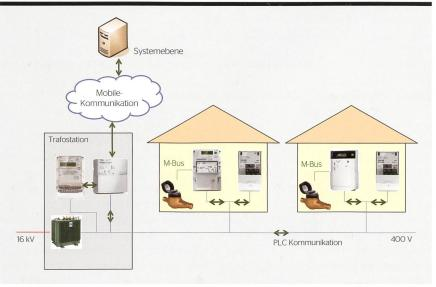
Bild 3 Topologie der eingesetzten Lösung zur Laststeuerung.
