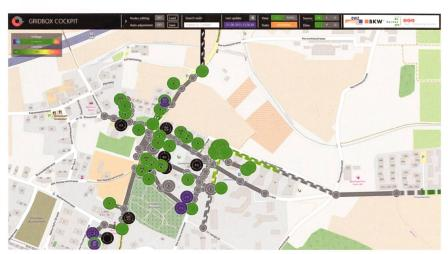
**Bild 2** Visualisierung des Netzzustandes mit aktuellen Messwerten aller GridBoxen und animierten Leistungsflüssen in der geografischen Ansicht.
