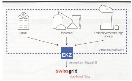
Bild 5 Virtuelles Kraftwerk der EKZ.
