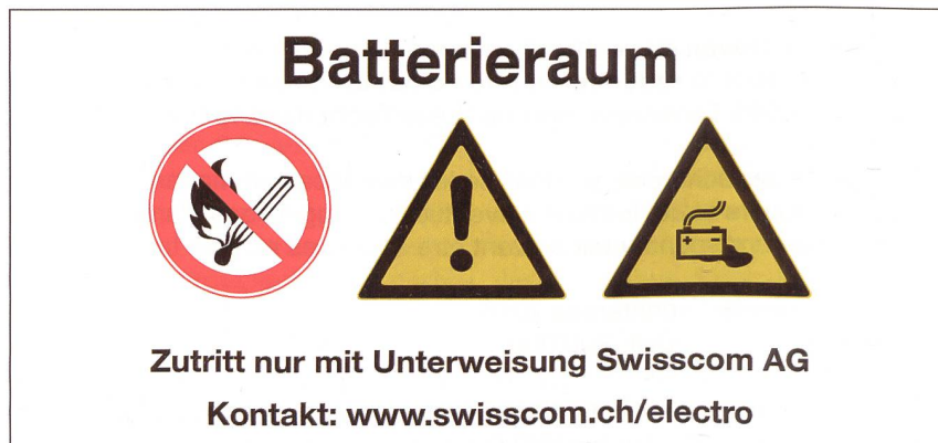
Bild 2 Sämtliche Batterieräume werden mit diesem Schild beschriftet (< 60 V Gleichspannung).
