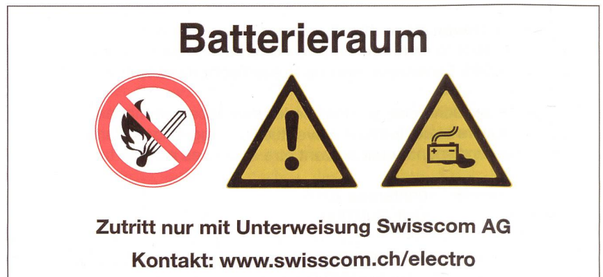
Bild 2 Sämtliche Batterieräume werden mit diesem Schild beschriftet (< 60 V Gleichspannung).
