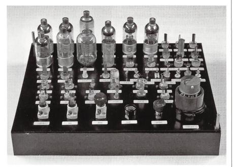
Bild 7 Ein Grossteil der bei Cerberus entwickelten und produzierten Kaltkathodenröhren.
