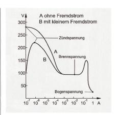
Bild 2 Kennlinie der Kaltkathodenröhre.
