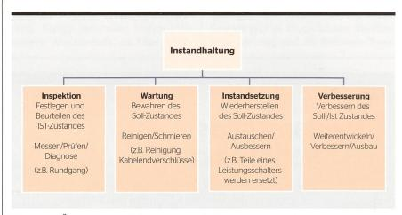
**Bild 1** Eine Übersicht über die Prozesse bei der Instandhaltung der Verteilanlagen.
