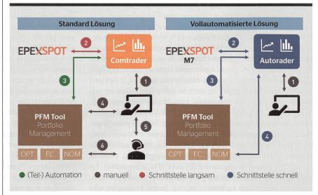
Bild 4 Vergleich von standardisierter und vollautomatischer Intra-day-Abwicklung.
