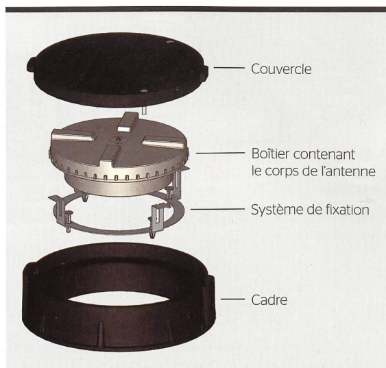
Figure 1 Éléments constitutifs de l'antenne développée pour une installation souterraine.
