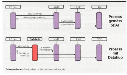
**Bild 5** Prozess «Lieferantenwechsel» mit und ohne Datahub. Aus Sicht des VNB ist eine vereinfachte Prozessabwicklung mittels Shortcuts möglich.
