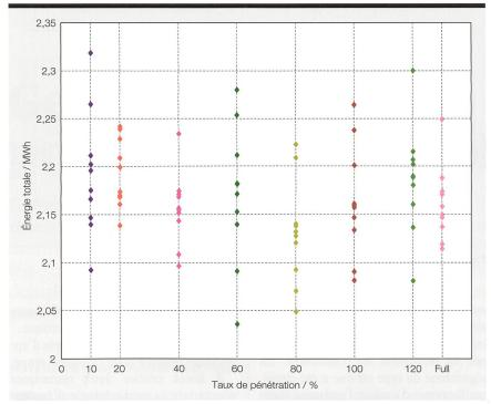
Figure 3 Énergie totale consommée par le réseau électrique.
