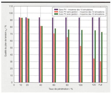
Figure 5 Qualité du plan de tension du réseau électrique.
