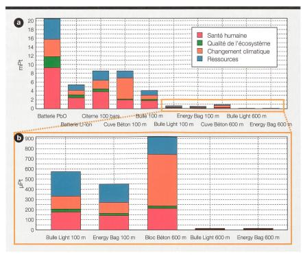
**Figure 2** Comparaison selon Impact 2002+ <sup>2)</sup> (unité fonctionnelle: pouvoir stocker 1 MJ dans un réservoir de capacité de 10 900 MJ) [5] (a) et agrandissement des résultats obtenus pour les moyens de stockage dont l'impact est le plus faible (les scores des scénarios « Bulle Light 600 m » et «Energy Bag 600 m » sont inférieurs à 1 pour mille de ceux de la batterie PbO).
