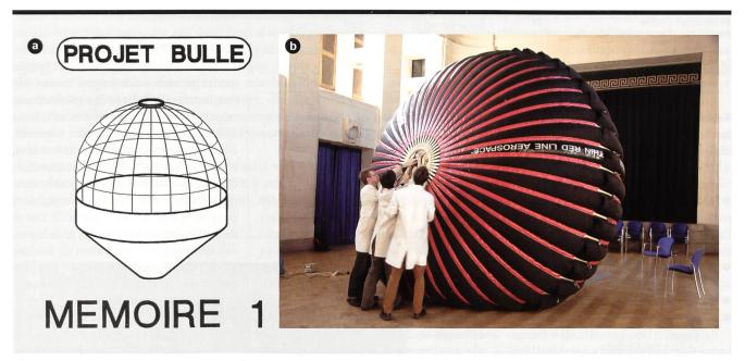
**Figure 1** Exemples de réservoirs hydrostatiques souples: projets « Bulle » – l'idée de stockage pneumatique a été explorée à l'EIG dès 1995 sous ses aspects de génie civil – [2] (a) et « Energy Bag » de l'Université de Nottingham [3] (b).
