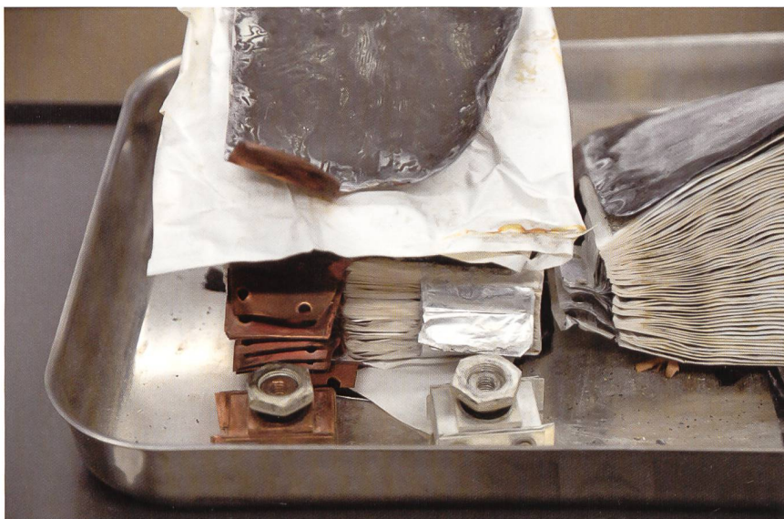
In Li-Ionen-Akkus hat es deutlich mehr Kupfer und Aluminium als Lithium.
