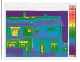
Die Europäische Kommission hat Vorschläge gemacht, um die Energieeffizienz von Gebäuden zu erhöhen. Das Infrarotbild zeigt rechts ein Eckhaus mit Aussenwärmedämmung. Damit sind die Oberflächentemperaturen entsprechend tief und der Energieverlust ist wesentlich kleiner als beim Haus links.
