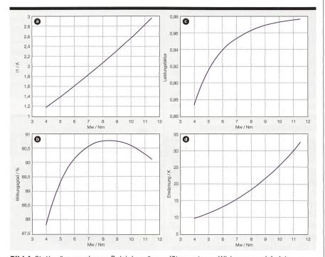
**Bild 4** Stationäre synchrone Betriebsgrössen (Strangstrom, Wirkungsgrad, Leistungsfaktor und Wicklungserwärmung) des 4-poligen PMLS-Motors der Bemessungsleistung von 1,5 kW in Abhängigkeit der Last.
