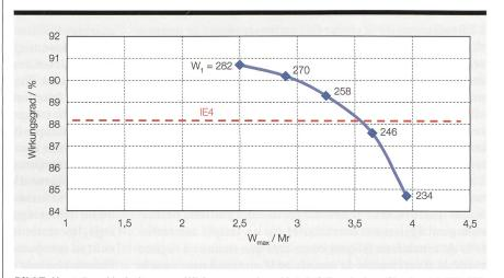
**Bild 7** Konträres Verhalten von Wirkungsgrad und Intrittfallverhalten für den 1,5-kW-PM-LS-Motor in Abhängigkeit der Wicklungsauslegung ( $W_1$  = Strangwindungszahl), für eine quadratische Lastkennlinie W ~  $n^2$  und ein Schwungmassenverhältnis von  $J_{Last}/J_{Motor}$  = 5.
