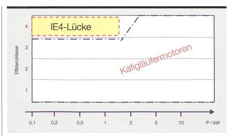
Bild 1 IE4-Produktlücke bei AC-Line-Start-Motoren.
