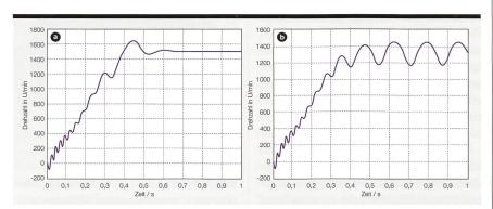
**Bild 5** Hochlaufvorgang mit finalem Intrittfall (a) und Hochlaufvorgang, der ohne Intrittfall in einem asynchronen Grenzzyklus mündet (b).
